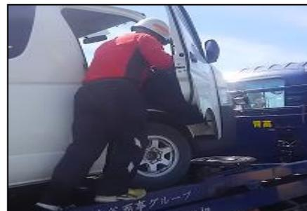
スリングベルトはロアアームの左右に必ず通し2本掛けで行い、万が一の事を考え第3の帯を車輛とウィンチで繋ぎ帯が切れた場合の落下防止を行う事を徹底し、更にウィンチが切れるなどを想定し引き取り車両の後方に充て木を置き、万が一の際に落下速度を軽減させる事で大きな事故を防ぐ為に必ずあて木を設置する事。
