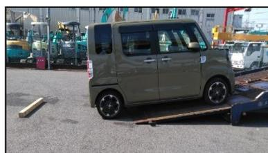
過去には荷降ろし作業中にウィンチを使用せず降ろした結果積車が傾斜した際に車輛が落下する事故が発生しております!
